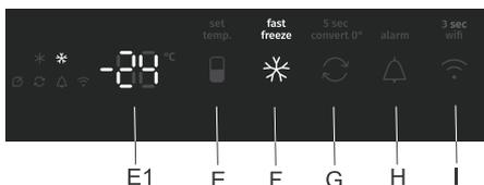
**Per attivare:** per attivare la funzione di congelamento intensivo (**super freeze**), premere il tasto **F**. Si sentirà un segnale acustico e l'indicatore **super freeze** si accenderà.
